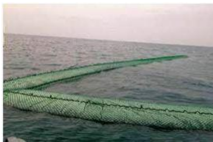
شکل ۸- لوله‌ی پلاستیکی (مشک ماری) حمل و نقل دریایی سوخت،
